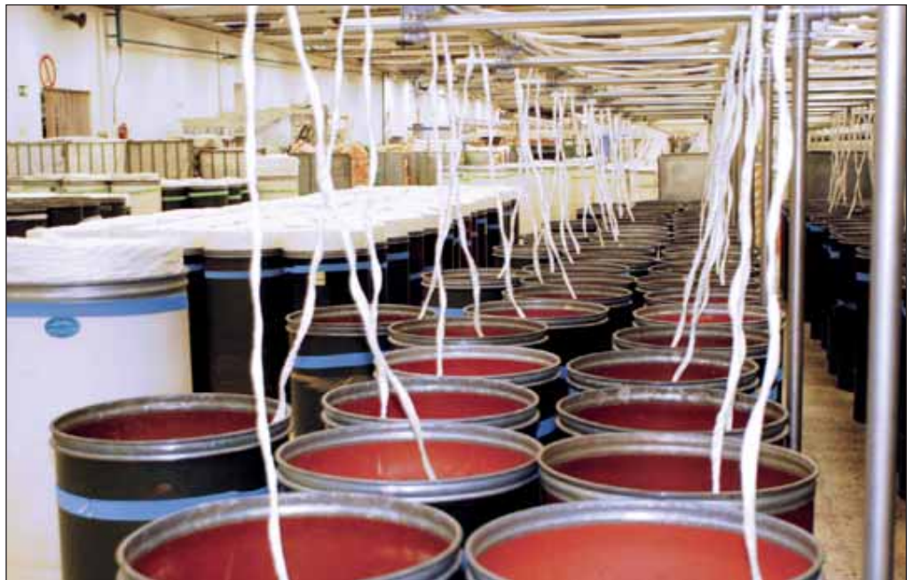
Hilado en la planta de Cabezón de la Sal. A partir de las balas de algodón se forman mechas que en sucesivos procesos van convirtiéndose en hilos de distintos calibres.
